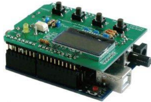
図1 マイコンボードと専用のシールド
