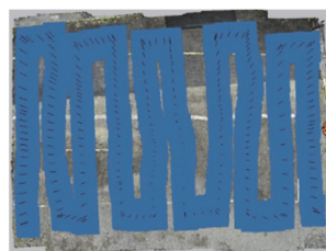
図-3 道路面の撮影位置
