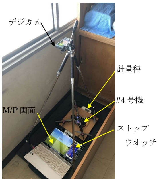
図 12. 静止推力・電力消費量測定状況
