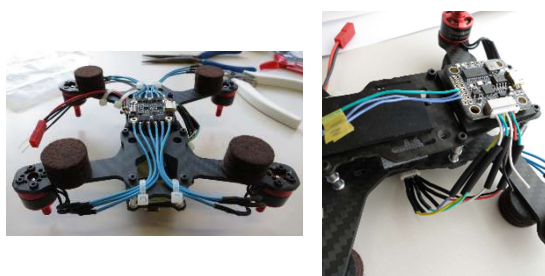
図 3. ドローン組み立て・配線状況
