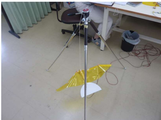
図.5 推力測定状況
