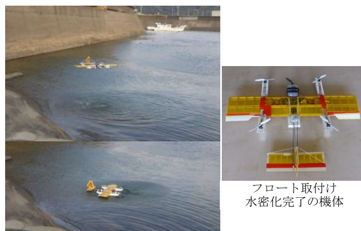
図.1 水上化改修した VTOL 型ドローン
