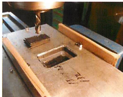
図1 損傷除去模擬切欠き孔の加工
