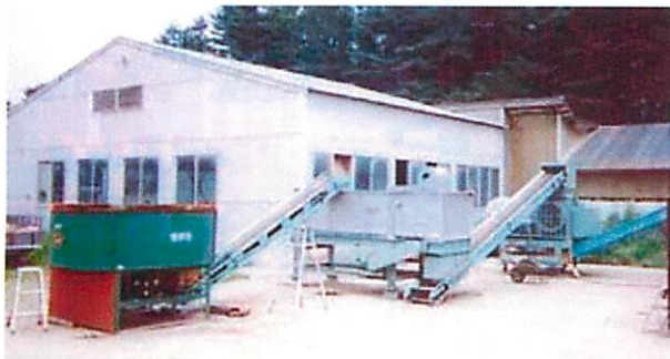
図-1 実験装置 (左から、混合機、定量供給機、高速破砕機)
