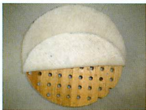
図3 脱臭槽底部の通気盤および不織布
