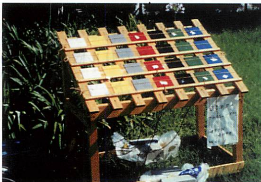
写真-1 表面温度の測定状況
