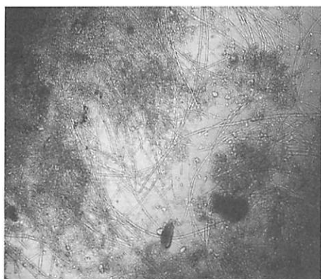
(a) 細菌のフロックを土台として広がる糸状菌と原生動物繊毛虫類
