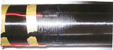
図10 単純支持梁の破断
