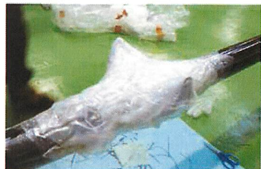
図1-6 真空引き時の水平尾翼取付部
