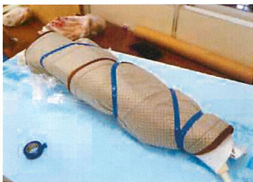
図8 加熱によるエポキシ樹脂の硬化
