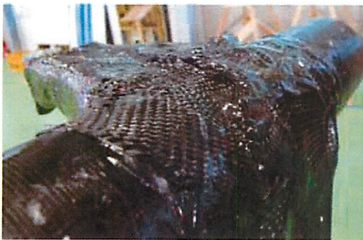
図18 真空引きをせず成型した垂直尾翼取付部
