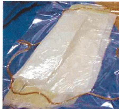
図6 大気圧による圧着（スラスト面）
