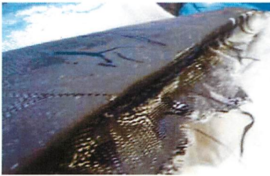
図1-4 巻き込みが生じた後縁
