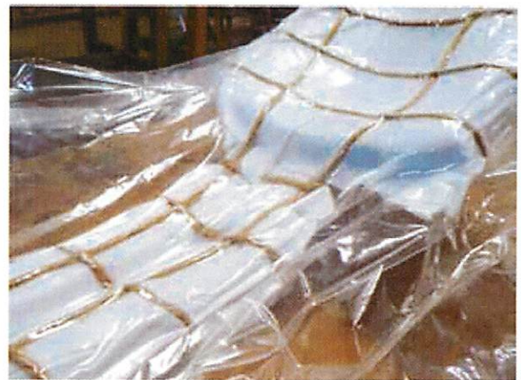
図1-5 真空引きした状態のシート
