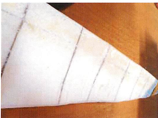
図2 全面に渡り液垂れしたエポキシ樹脂
