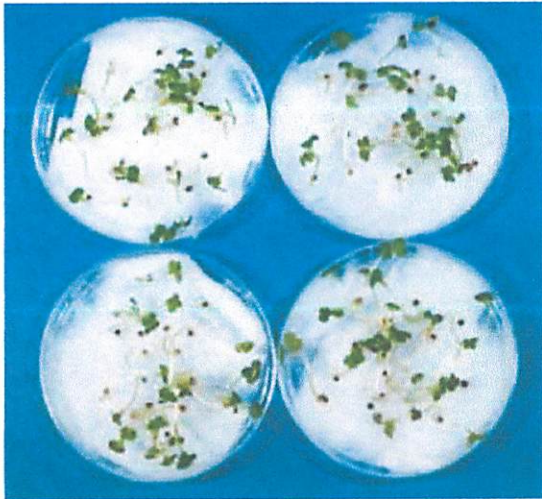
図—10 中和液による小松菜の発芽試験(Ca(OH) 2 1.5g/l を H 2 SO 4 で pH7.2 まで中和した)
