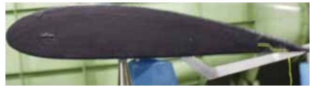
風洞に設置した翼模型
