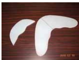
図1:アルソミトラの模型 (幅 15cm、重さ 0.2g) (H21年度卒研成果)
