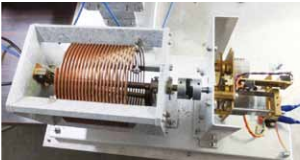
図 30 可変インダクタンス素子とドライブ回路
