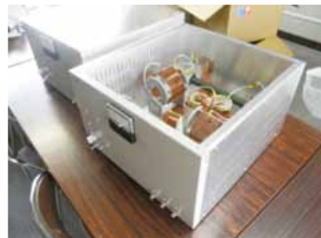
写真 1 製作した 3dB カップラ外観 (100W 対応)
