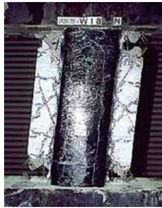
図-2 炭素繊維シートによる補強 (2)
