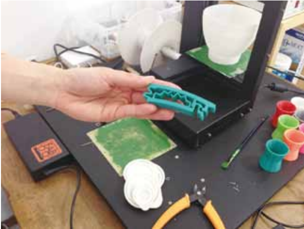
図5 3Dプリンターでつくったポテトチップスの袋の口を止めるクリップ（渋谷ファブラボ取材にて撮影）
