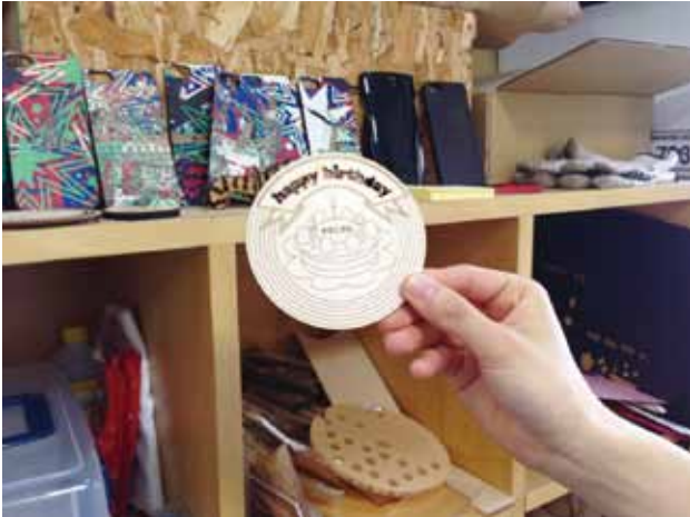
図6 レーザーカッターで作成したオリジナルデザインのコースター（前）と、3Dプリンターで作成したオリジナルデザインのスマホカバー（後）（渋谷ファブラボ取材にて撮影）
