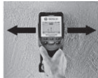
図-1 鉄筋探査機 (BOSH 社カタログ)
