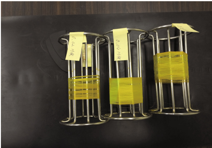
太さの異なる 3 種類の川俣シルク (紫外線染色) 左から 0.02 mm、0.04 mm、0.06 mm
